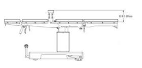
Длина стола 2,020 мм Ширина стола (без боковых ограждений) 520 мм Высота стола (без матраса) 650 мм-940 мм 20°/20° Тренделенбург/обратный 20°/20° Боковой наклон (влево/вправо) 75°/25° Спинная пластина вверх/вниз Головная пластина вверх/вниз (съемная) 30°/45° Ножная пластина вверх/вниз (съемная) 5°/90° 180° Ножная пластина раздельная (съемная) 110 мм Подъемник почечного моста вверх Продольное смещение 300 мм Грузоподъемность Входная мощность (Гц) AC 90V-264V 50/60
